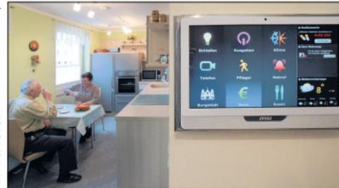
Blick in eine altersgerechte Musterwohnung: Mit dem Display können Funktionen wie automatisches Ausstellen des Lichtes, Bedienung der Klimaanlage, Erinnerung an Tablettenaufnahme oder Notruf gesteuert werden.
